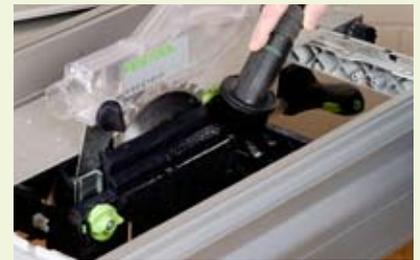
**1.** Staub und Schmutz absaugen: Damit die Maschine exakt und sauber zuschneidet, ist es zunächst wichtig Staub- und Schmutzablagerungen regelmäßig von der Säge durch Absaugen zu entfernen. Benutzen Sie auf keinen Fall Druckluft zum Säubern, da auf diese Weise sehr schnell Staub in Motor, Elektronik oder Führungsstangen gelangt. Die Führungsstangen sollten danach jedesmal leicht eingefettet werden, damit die Zugfunktion auch leichtgängig und ruckfrei funktionieren kann.
