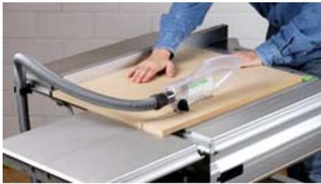
Wurde die Tischverlängerung montiert, kann das Sägeblatt in der hinteren Position bleiben. Dadurch ergibt sich vor und hinter dem Sägeblatt auch für größere Werkstücke genügend Auflage.
