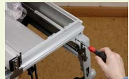
**3.** Dämpfer nachjustieren: Ein Dämpfer bewirkt, dass das Sägeaggregat über die gesamte Zuglänge gleichmäßig zurückläuft. Der Dämpfer kann durch die Bohrung nachgestellt werden. Im übrigen ist die CS 50 mit selbstabschaltenden Spezialkohlen ausgerüstet. Sind diese abgenutzt, erfolgt eine automatische Stromunterbrechung und die Maschine kommt zum Stillstand. Nachdem die Spezialkohlen durch eine autorisierte Kundendienstwerkstatt erneuert wurden, ist die Säge wieder betriebsbereit.
