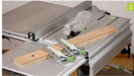
Alles was Sie neben einer Tischkreissäge dazu benötigen, ist eine ca. 80 mm breite und 20-25 mm dicke Holzleiste (z.B. Multiplex-Birke) in der Länge des Längsanschlags. In diese Holzleiste bohren Sie 100 mm vom Ende je ein 25 mm großes Loch, in das Sie später je eine Zwinde einstecken. Zur Befestigung der Holzleiste sollten Sie wieder so genannte Hebelzwingen einsetzen, die sich im Gegensatz zu Schraubzwingen auch bei stärkeren Vibrationen nicht lösen können.
