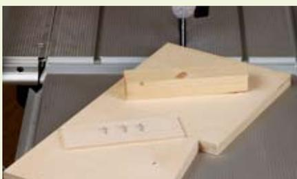
Mit der entsprechenden Vorrichtung lassen sich auch Keile gefahrlos und präzise mit einer Tischkreissäge zuschneiden. Dazu benötigen Sie ein Holzbrett in der gleichen Stärke wie das Brett aus dem die Keile gesägt ...
