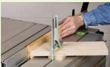
Mit der Tischkreissäge kann man hervorragend nuten und falzen. Bei beiden Anwendungen handelt es sich um verdeckte Sägeschnitte, bei denen zunächst die Spanhaube abmontiert und der Spaltkeil versenkt werden muss. Während beim Nuten einfach ...
