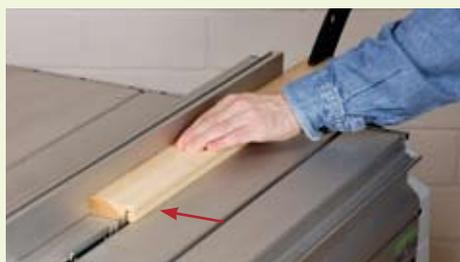
... mehrere Schnitte nebeneinander gemacht werden, bis die Nutbreite erreicht ist, muss beim Falzen das Werkstück zunächst hochkant und anschließend flach am Parallelanschlag vorbei geschoben werden. Dabei ist es besonders wichtig, dass sich beim ...
