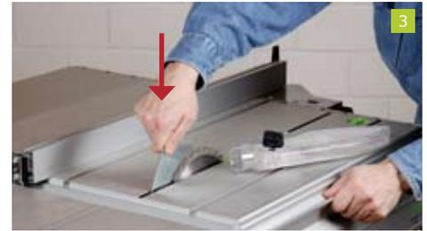
Entfernen Sie zuerst die Absaughaube aus Plexiglas. Anschließend können Sie den Spaltkeil – ohne Lösen einer Schraube – einfach nach unten drücken, bis er in der tiefsten Position (ca. 2 mm niedriger als der höchste Sägeblattzahn) einrastet. Auf keinen Fall dürfen Sie den Spaltkeil komplett entfernen und denken Sie daran: niemals ohne Spaltkeil sägen!
