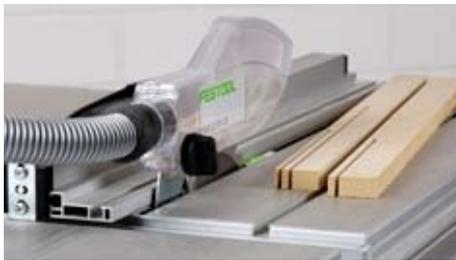
Sollen besonders schmale Leisten zugeschnitten werden, muss das Alulineal am Anschlag in eine flache Position gebracht werden, damit es nicht gegen die Spanhaube stößt. Jetzt können sogar extrem schmale Leisten (Anleimer, Glashalteleisten etc.) präzise und gefahrlos zugeschnitten werden - und auch der Schiebestock kann problemlos eingesetzt werden.
