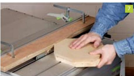
Wichtig ist, dass die Schablone mit seitlichem Druck exakt an der Leiste vorbei geführt wird, damit keine Ungenauigkeiten an den Kanten des Werkstücks entstehen. Sollte dennoch einmal etwas nicht so präzise sein wie Sie es sich vorstellen, wiederholen Sie den Vorgang. Solange die Schablone auf dem Werkstück befestigt ist, lässt sich dies beliebig oft wiederholen.
