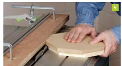
Um kleinere Werkstücke als die Schablone herzustellen, müssen Sie nur den Parallelanschlag samt Führungsleiste vom Sägeblatt wegschieben. Der Abstand zwischen Führungsleiste und Außenseite des Sägeblatts bestimmt dabei die Verkleinerung. Bei einer Vergrößerung wird die Führungsleiste weiter über das Sägeblatt heraus bewegt. So lassen sich Vergrößerungen bzw. Verkleinerungen bis ca. 6 cm herstellen.
