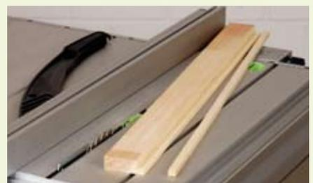
... zweiten Sägeschnitt der Abschnitt bzw. die Leiste nicht zwischen Sägeblatt und Anschlag befindet, sondern frei nach außen weggenommen werden kann (s. Pfeil Foto Mitte). Diese Leiste kann dann auch gleich z. B. als Glashalteleiste eingesetzt werden.
