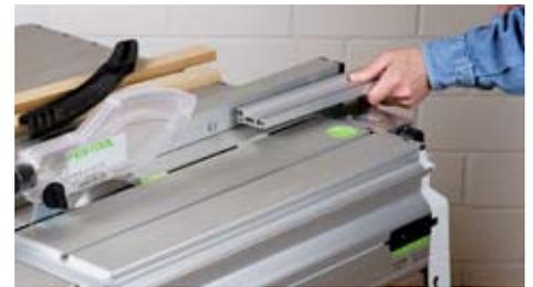
Um das Alulineal zu schwenken, werden einfach die beiden Befestigungsschrauben auf der Rückseite des Anschlags gelöst und das Alulineal nach vorne heraus gezogen. Anschließend wird es - mit dem anderen Ende und flach zur Seite gekippt - wieder mit seiner T-Nut auf die beiden Vierkantmuttern geschoben und mit den beiden Befestigungsschrauben gesichert.
