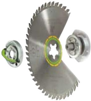
Der Sägeblattwechsel selbst, ist in weniger als zwei Minuten erledigt. Dazu muss nur der Griffbügel der Spannmutter (Pfeil) nach außen geklappt und die Mutter im Uhrzeigersinn (Linksgewinde) aufgedreht werden. Die Spannmutter darf nur von Hand geöffnet werden und es darf auf keinen Fall ein Schraubendreher in den Griffbügel gesteckt
