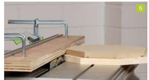
Das Prinzip des Kopierens ist so simpel wie genial: Während die Schablone an der Führungsleiste vorbei geschoben wird, sägt das darunter laufende Sägeblatt den Überstand des Bretts exakt auf das Maß der Schablone zu. Dadurch sind alle Arten von gerade verlaufenden Außenecken perfekt zu kopieren, ohne jedes Brett neu anzeichnen zu müssen. Innenecken und geschweifte Kantenverläufe können nicht nach dieser Methode kopiert werden, da hilft nur die Oberfräse weiter.
