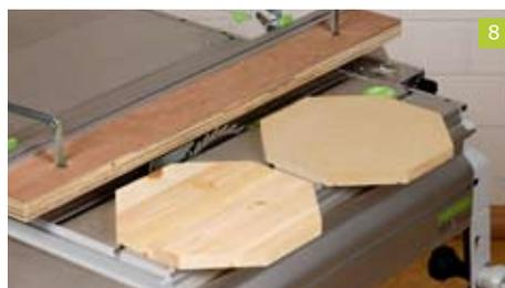
Dieses Bild zeigt die genaue 1:1 Kopie der Schablone eines Achtecks. Haben Sie einmal die Schablone für Ihre Form hergestellt, benötigen Sie lediglich zwei Minuten, um eine exakte Kopie davon zu sägen. Jedes weitere Brett ist eine exakte Kopie der Schablone. Dies führt zu einer Genauigkeit, die mit keiner anderen Methode in dieser kurzen Zeit erreicht werden kann.
