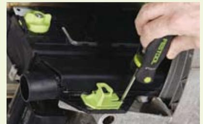
**2.** Absaugkanal reinigen: Schnittreste und Staubablagerungen können Sie aus der unteren Schutzhaube entfernen, indem Sie den grünen Schieber betätigen und die Klappe öffnen. Wenn Sie die Schraube herausdrehen lässt sich die Klappe auch vollständig öffnen. Vergessen Sie aber nicht vor Inbetriebnahme die Klappe wieder vollständig zu schließen!
