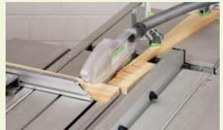
... festspannen, müssen Sie das Anschlaglineal des Parallelanschlags in die flache Position bringen (Pfeil Foto Mitte) und so weit zurück ziehen, dass der Anfang des Sägeblatts in etwa dem Anfang des Anschlaglineals entspricht (Pfeil Foto links). Die Abschnitte dürfen vom Anschlag nicht eingeklemmt werden!
