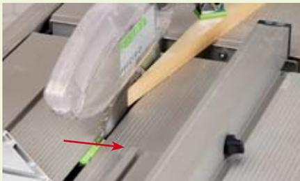
Wenn Sie beispielsweise von einer schmalen Holzleiste mehrere gleich kurze Holzklötzchen abschneiden möchten, müssen Sie sich zu-nächst eine so genannte Abweisleiste zuschneiden. Diese keilförmige, spitz zulaufende Holz-leiste wird dann mit zwei Hebelzwingen so auf den ...
