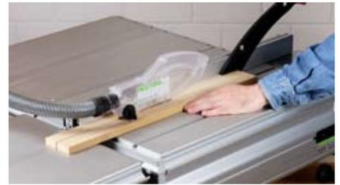
Bei Werkstücken, die schmaler als 12 cm sind, muss unbedingt ein Schiebestock benutzt werden. Denken Sie immer daran, ein Schiebestock ist ersetzbar - die Hand bzw. Finger nicht!"
