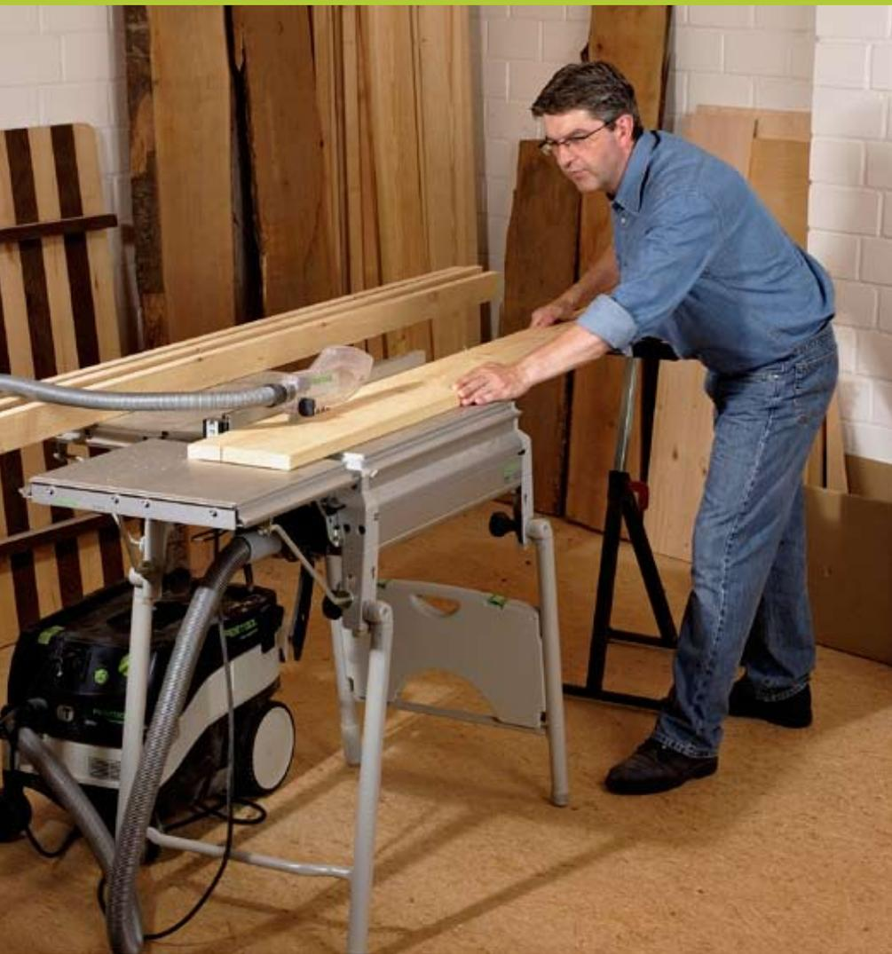
Bei der CS 50 können Sie das Werkstück wie bei herkömmlichen Tischkreissägen ins Sägeblatt schieben (links) oder das Werkstück auf der Tischfläche auflegen, festspannen und anschließend einfach das Sägeblatt ins Werkstück hinein ziehen (unten).
