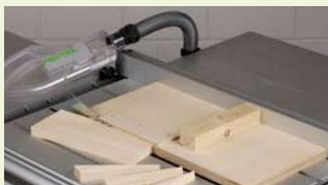
... werden sollen. In die Längskante des Bretts wird die Form des Keils mit einer Stichsäge geschnitten. Auf diese Ausklinkung wird ein Sperrholzbrettchen geschraubt, damit der Keil während des Sägens nicht heraus geschleudert wird.
