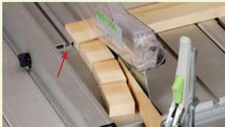
... Säge Tisch gespannt, dass die Spitze etwa die Mitte des Sägeblatts ganz leicht berührt (s. Foto links und rechts). Die Leiste verhindert so, dass abgesägte Holzklötzchen von den hinteren aufsteigenden Sägeblattzähnen erfasst und gegen den Anwender geschleudert werden. Bevor Sie die Abweisleiste ...
