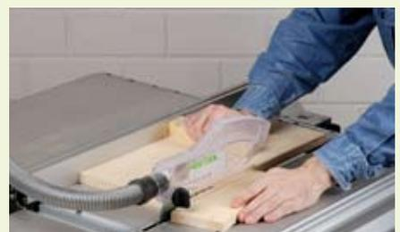
Ein aufgeschraubter Holzklötz dient zum Schieben der Vorrichtung. Dann wird das Brett aus dem die Keile gesägt werden, einfach in die Ausklinkung gelegt und zusammen mit der Vorrichtung am Anschlag vorbei geschoben.
